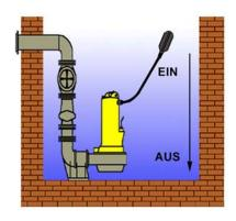
Bei diesem Verfahren werden Schaltkontakte in einem Schwimmkörper in Abhängigkeit des Neigungswinkels geschlossen oder geöffnet
