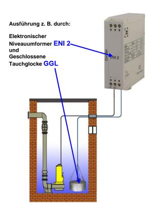
Bei diesem Verfahren wird die Niveauänderung über einen Druckschlauch oder ein Staurohr auf die Sensorik übertragen und dort ausgewertet. Man unterscheidet geschlossene und offene Systeme.
