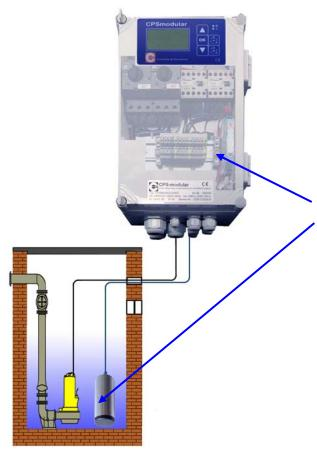
Bei diesem Verfahren wird eine Druckmesszelle über ein abgedichtetes Gehäuse in das Medium eingehängt. Der Füllstandsdruck wirkt direkt auf den Piezosensor und wird als analoges elektrisches Signal in Form von 4 - 20 mA über die Leitung übertragen.
